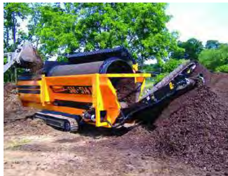
Figure 17. Trommel screen (Doppstadt US 2012)
